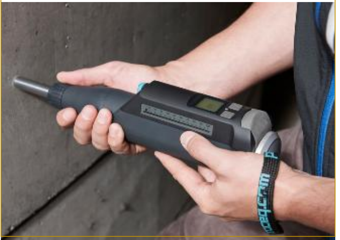
الشكل 18: صورة توضيحية تبين استخدام جهاز المطرقة البيتونية الرقمية.
