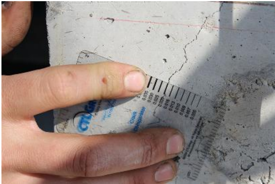
الشكل 15: أداة قياس التشققات اليدوية وطريقة قياس الشقوق.
